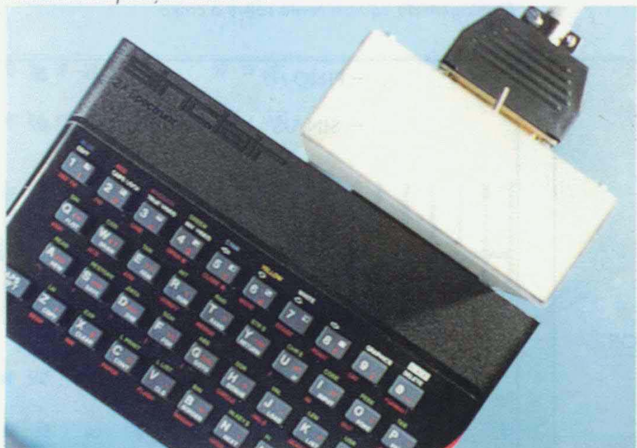
9 Vista geral do equipamento já conectado ao SPECTRUM, pronto para iniciar o funcionamento, enquanto introduzimos o programa. Pode-se apreciar na imagem o conector cannon macho que leva os cabos.
