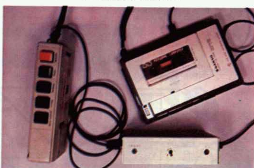
6 Duplicação de um programa para o ZX81, armazenado em uma fita cassete, sem necessidade de empregar o microcomputador e sem perder a qualidade na gravação. Os dois gravadores deverão estar em perfeitas condições de funcionamento.
